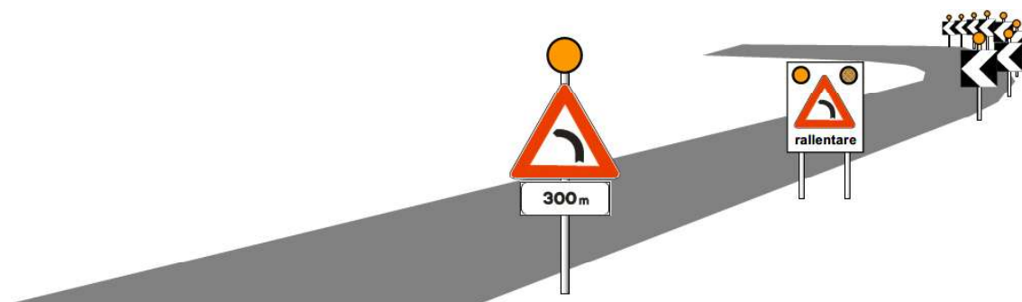
Figura 2: Esempio di applicazione dei dispositivi luminosi di pericolo e sicurezza utilizzati a rinforzo della segnaletica verticale passiva in una delle più classiche applicazioni.
